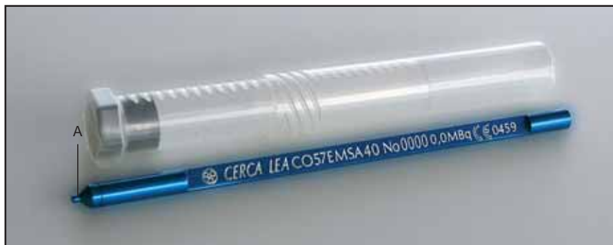
A : dépôt radioactif Longueur : 185 mm - Diamètre : 8 mm
