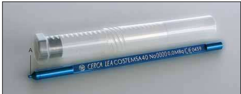
A : dépôt radioactif Longueur : 185 mm - Diamètre : 8 mm
